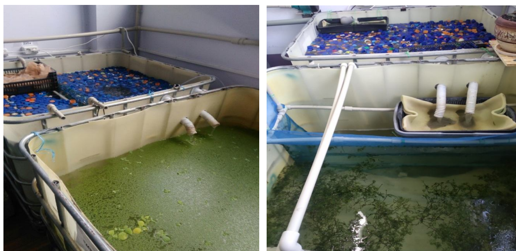
Рисунок 4 Биофильтры и биоплаты в УЗВ цеха выращивания товарной рыбы
